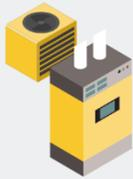
Ajout d'une thermopompe à air; maintien du nouveau générateur d'air chaud à condensation alimenté au gaz comme chauffage d'appoint.
