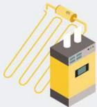
La fournaise au gaz au rendement de 94% a été remplacée par une thermopompe géothermique de 370% d'efficacité. Le foyer au gaz a été enlevé et le raccordement au réseau de gaz a été supprimé.
